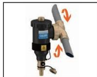
ブライン内の分離された気泡は、上部キャップのネジをドライバーでゆるめ、排気します。接続部を可動させて、縦・横配管に対応します。
