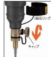
内部に備えられた網(①)に、ブライン内の不純物がぶつかり、排出ポケット(②)に落ちる仕組みです。必要な時に排出バルブ(④)を開き、ためた汚れを排出します。同時にブライン内の気泡を集め、上部キャップを手動でゆるめて放出できます。これまでのフィルタによるろ過とは違うやり方でメンテナンス性を高めます。
